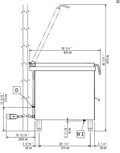
D Drain Electrical inlet (power) ΕI Equipotential screw EQ Water inlet
